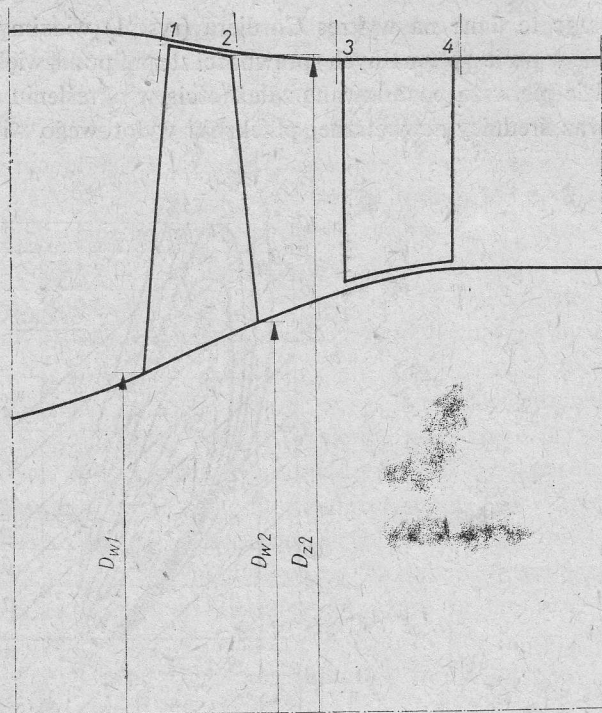
Rys. 2. Schemat sprężarki transonicznej NASA [16]
