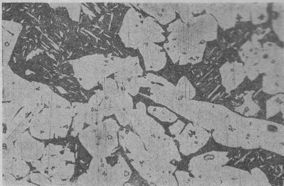
Rys. 16. Szczegół z rys. 14. Charakterystyczne zgrupowanie eutektoidu pomiędzy ziarnami \alpha
