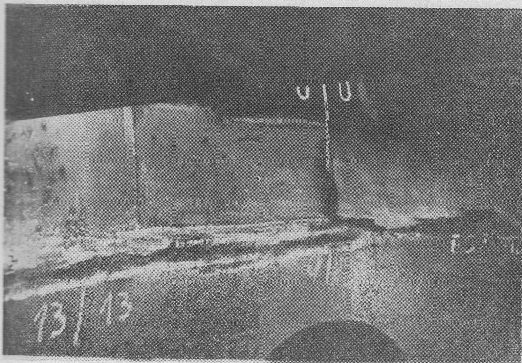
Rys. 14. Stan powierzchni osłony wirnika regenerowanej za pomocą napawania proszkami, po 1821 godz. pracy jednostki
