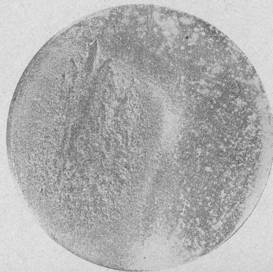
Rys. 6. Charakterystyczne układy wżerów kawitacyjnych; a) wżery odosobnione (układ punktowy) na piąście wirnika pompy i na próbce ze stali węglowej poddanej działaniu kawitacji „zrywowej” o małym natężeniu, b) wżery w postaci bruzd (układ pasmowy) na łopatkę wirnika pompy oraz na próbce ze stali węglowej poddanej działaniu kawitacji „zrywowej” o dużym natężeniu,
