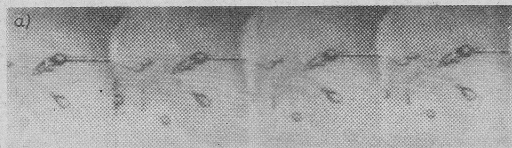
Rys. 10. Kropla i struga przed kolizją ( v = 150 \cdot 10^3 \text{ s}^{-1} )
