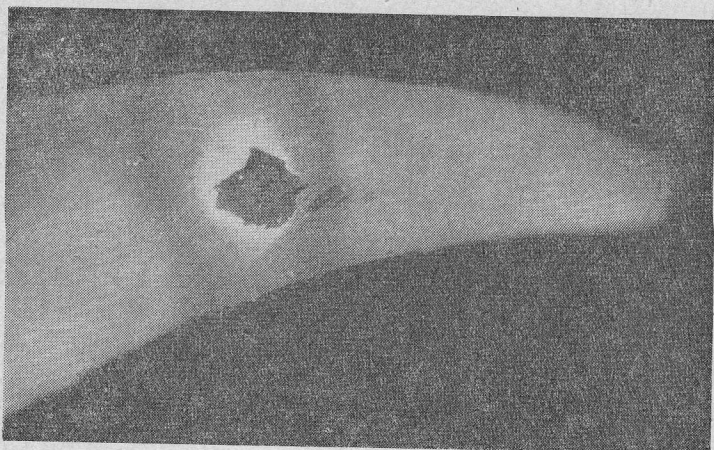
Rys. 4. Makroskopowy obraz powierzchni nagrzanej palnikiem po wytrawieniu chlorem żelaza, pow. 3\times . Ciemne miejsca – obszar bezpośredniego oddziaływania stożka płomienia, wokół – strefa koncentryczna oddziaływania żagwi, obszar odwęglony
