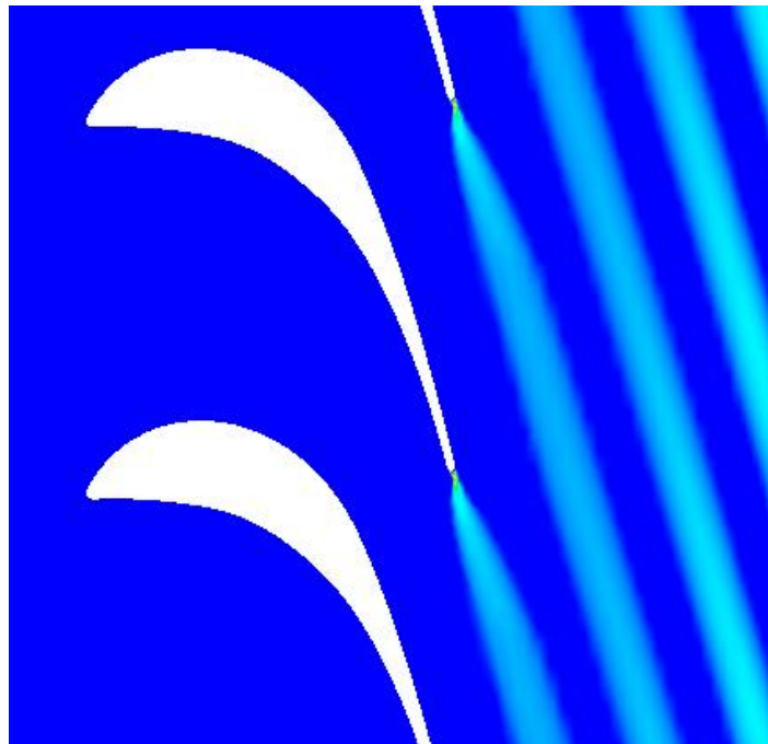
Rys. 5.7. Efekt krawędzi spływu – powstawanie wirów
