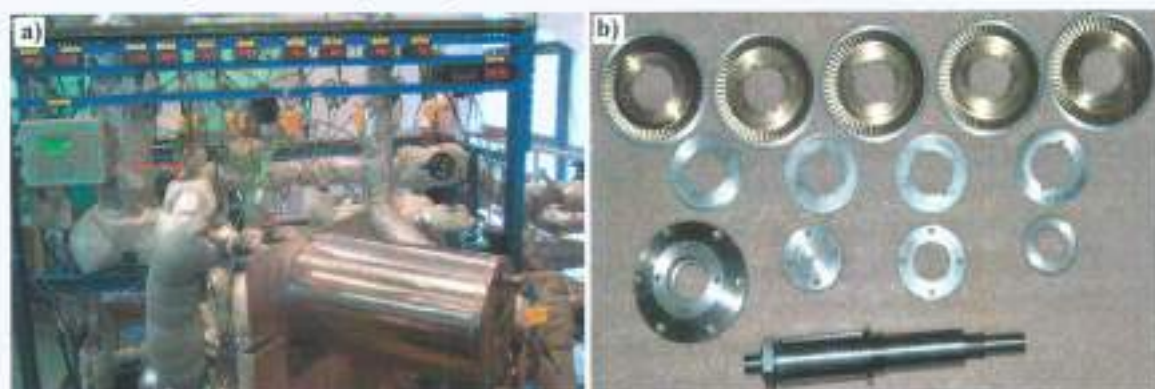
Rys. 3.7. Zdjęcia a) z badań mikroturbogeneratora osiowego oraz jej b) podstawowych elementów [AA16].
