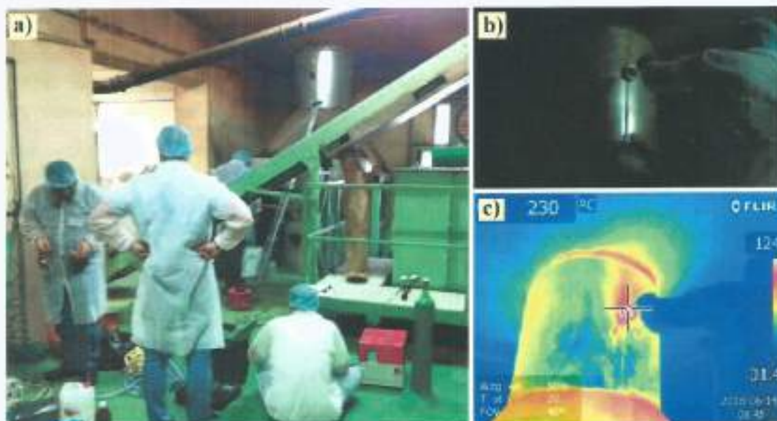
Rys. 1.7. Linia dopalania odpadów organicznych cząstek stałych w zakładzie produkującym żywność: a) przygotowania do pomiarów parametrów ciepła odpadowego b) pomiar temperatury spalin, c) obraz termowizyjny powierzchni komina [P9 – pkt. 25].
