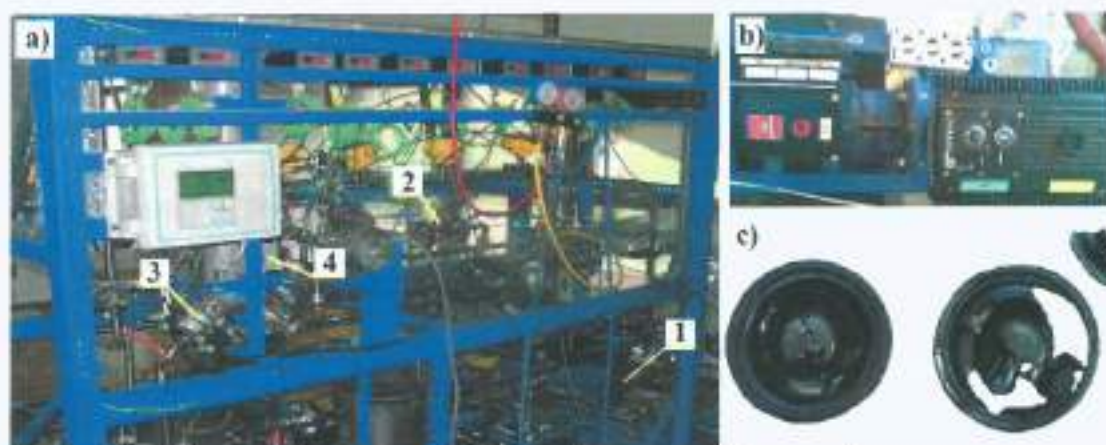
Rys. 1.8. Zdjęcie a) stanowiska badawczego ORC, b) zdemontowany badany membranowy agregat pompowy, c) uszkodzone membrany pompy: 1 – membranowy agregat pompowy, 2 – zawór ekspansyjny, 3 – regenerator (wymienник ciepła typu JAD), 4 – parownik (płytkowy wymiennik ciepła).
