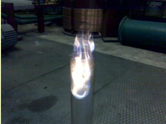
Test palności próbka gazu zebrana z pirolizy PET
