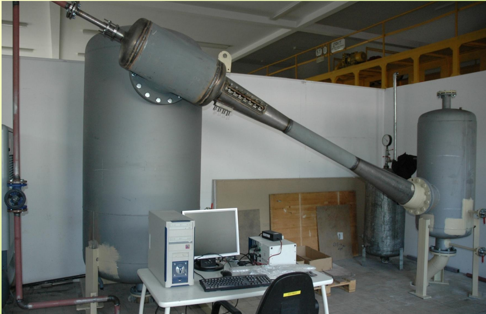
Stanowisko do badań układów strumieniowych dla District Cooling Systems
