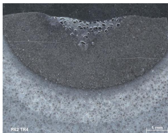
Rys. 8. Przekrój przez laserowo przetopiony stop Al 6061 z wstrzykniętymi ziarnami SiC; warunki eksperymentalne: laser diodowy, I = 340 \text{ W/mm}^2 , v_{sc} = 8.3 \text{ mm/s} , m_p = 2 \text{ g/min} , T_p = 340^\circ\text{C} .
