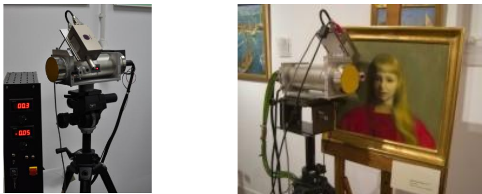
Rys. 1. Spektrometr fluorescencji rentgenowskiej (XRF) zbudowany w laboratorium IMP PAN
