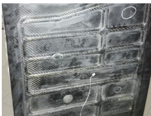
Rys. 7. Fragment konstrukcji lotniczej usztywnieniami wykonany z laminatu węglowo-epoksydowego
