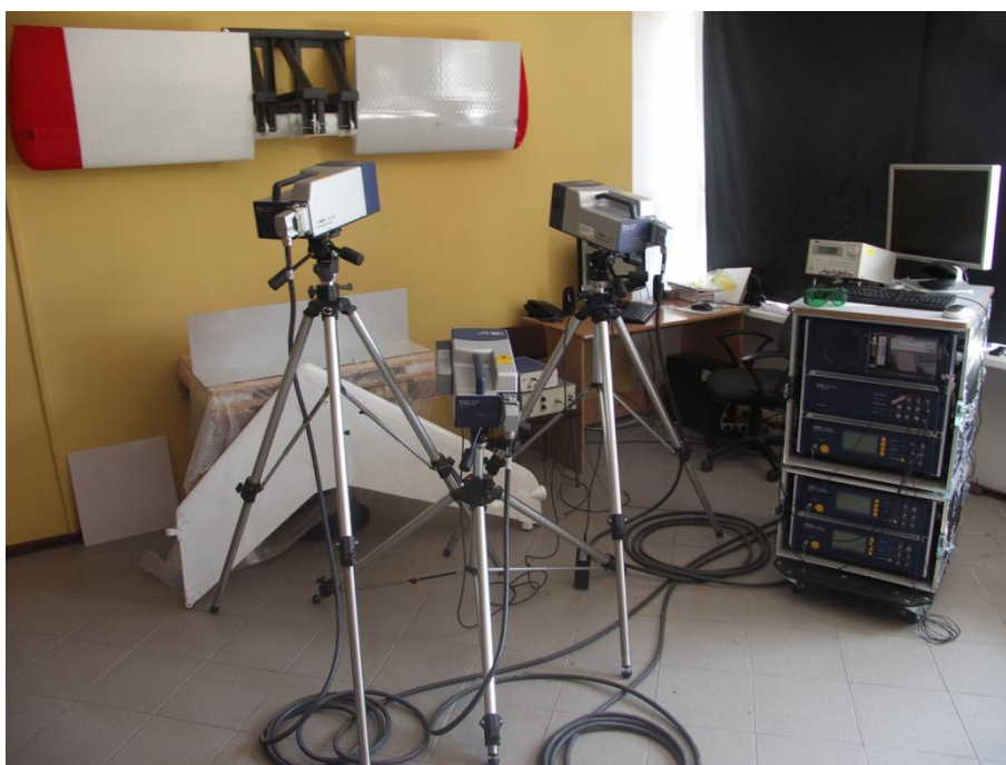
Rys. 1. Stanowisko do badań propagacji fal sprężystych z wykorzystaniem wibrometrii laserowej
