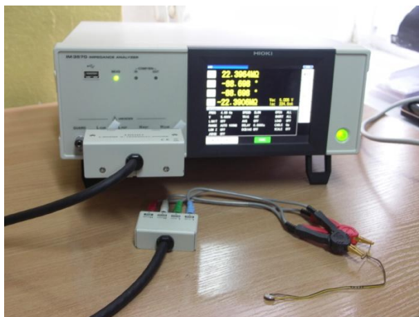
Rys. 13. Laboratoryjny analizator impedancji HIOKI IM3570
