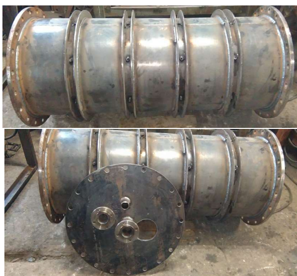
Rys. 13 Budowa reaktora zgazowującego odpady komunalne
