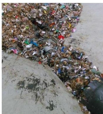
Rys. 22 Okresowe zawieszanie się paliwa w zasobniku
