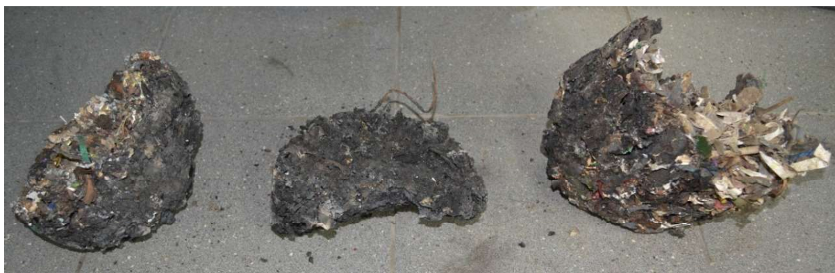
Rys. 7 Spieki powstające podczas zgazowania odpadów komunalnych
