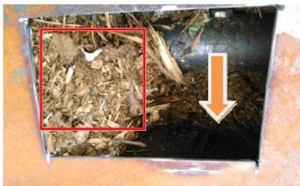
Rys. 20 Wlot paliwa do reaktora
