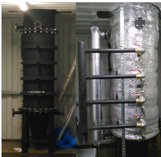
Rys. 14 Reaktor zgazowujący podczas montażu i jego końcowa postać
