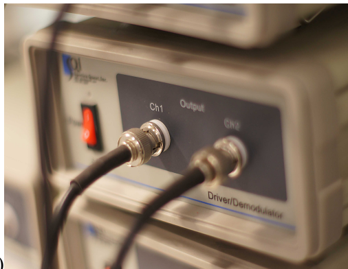
Rys. 3.2. a) Czujniki wiropędowe umieszczone pod kątem 90^\circ względem siebie i prostopadle do osi wirnika, b) demodulator – moduł służący do przetwarzania sygnałów z czujników wiropędowych
