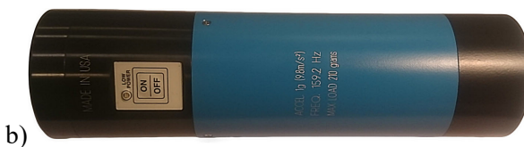
Rys. 3.3. a) Akcelerometr użyty do mierzenia przyspieszeń drgań podpór łożyskowych. b) Przenośny przyrząd do kalibrowania akcelerometrów
