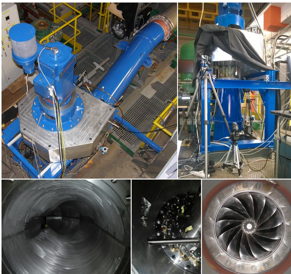
Rys.5.2.1. Zdjęcie lewe górne: niskospadowa wysokobieżna modelowa turbina Francisa zainstalowana na stanowisku eksperymentalnym IMP PAN; zdjęcie prawe górne – widok turbiny z boku; zdjęcie lewe dolne – wlot do spirali; zdjęcie środkowe dolne – układ przestawczy kierownicy; zdjęcie prawe dolne – widok wirnika turbiny o wyróżniku 82 od strony rury ssącej.
