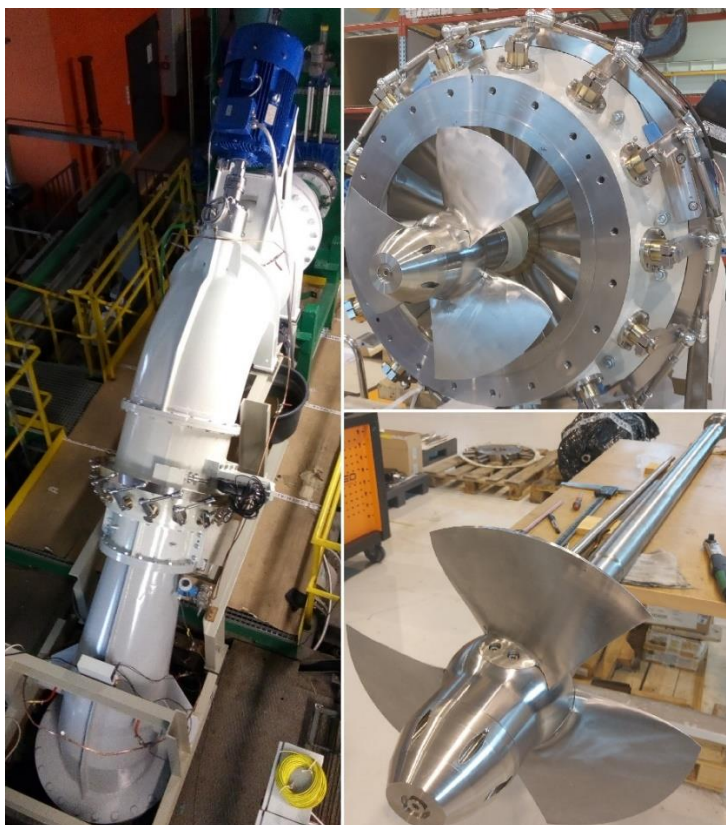
Rys.7.3.1.5. Niskospadowa wysokobieżna prototypowa turbina Kaplana z generatorem PMG (z wirnikiem o średnicy 500 mm), zamontowana na stanowisku do badań turbin wodnych w IMP PAN, przeznaczona do instalacji w EW Strużyska k/Piły oraz wieniec kierowniczy i układ wirnikowy przed montażem. [W2]
