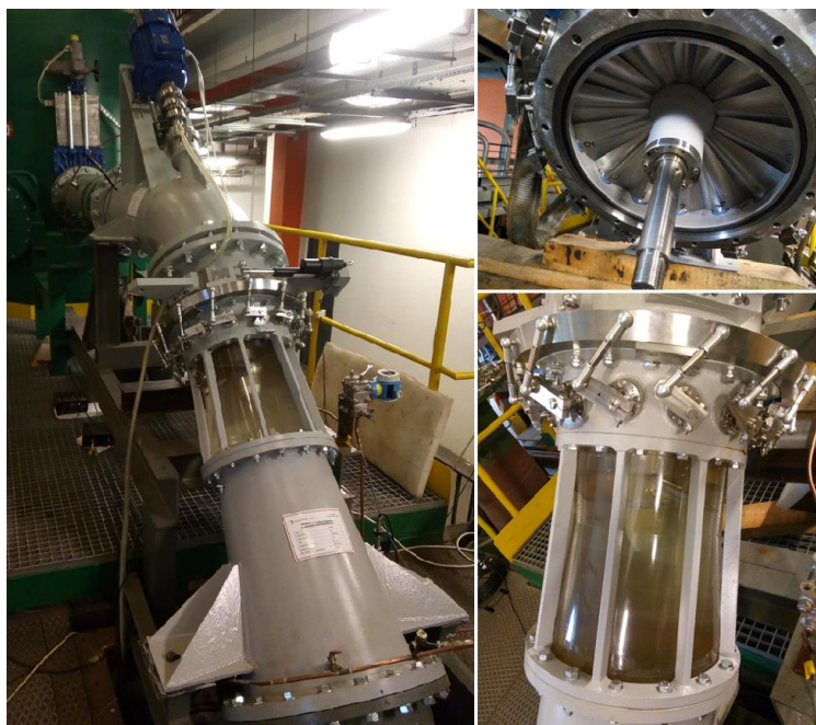
Rys.7.3.1.1. Niskospadowa wysokobieżna modelowa turbina Kaplana o wyróżniku 236 zamontowana na stanowisku do badań turbin wodnych w IMP PAN (zdjęcie lewe) oraz wieniec kierowniczy przed montażem (zdjęcie prawe górne) i wirnik w przezroczystej obudowie rury ssącej (zdjęcie prawe dolne).
