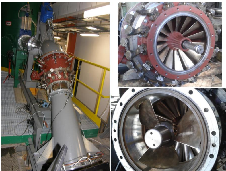
Rys.4.3.2. Zdjęcie lewe: niskospadowa wysokobieżna modelowa turbina Kaplana zainstalowana na stanowisku eksperymentalnym IMP PAN; zdjęcie prawe górne – wieniec kierowniczy; zdjęcie prawe dolne – wieniec wirnikowy.
