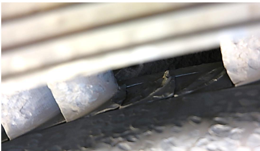
Rys. 23. Widok na urwane pióra łopatek promieniowych stopnia promieniowo - osiowego
