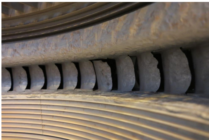
Rys. 22. Widok na uszkodzone łopatki promieniowe stopnia promieniowo - osiowego
