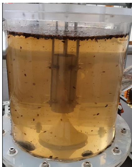
Rys. 40. Wpływ mieszania na stan mieszaniny w zakresie prędkości obrotowej 0-800 obr/min. (brak skutecznego mieszania).
