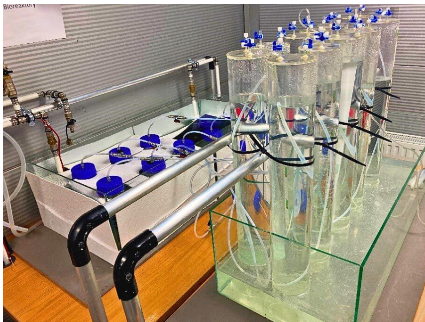
Rys.14. Instalacja do przeprowadzania procesu ciemnej fermentacji
